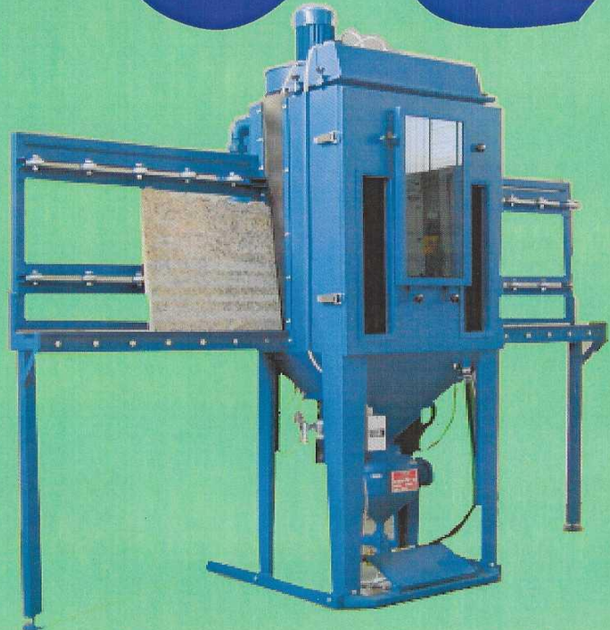
Cabina per sabbiatura aperta sopra, per il passaggio di lastre alte
